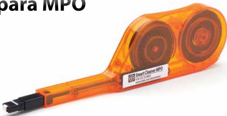
Diseñado para funcionar con los conectores MPO, este instrumento limpia los extremos de la férula eliminando el polvo, la grasitud y otros desechos sin mellar o rayar la superficie. El Smart Cleaner de SENKO es un paño seco para limpiar el conector MPO que consta de un mecanismo "de presión hasta escuchar un clic". Como las otras series del Smart Cleaner el diseño de la tapa de protección actúa como un adaptador para limpiar los conectores no acoplados.
