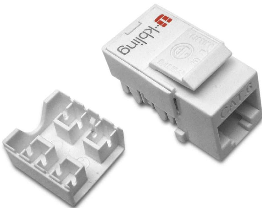
Módulos UKBLING Categoría 6 UTP tipo Keystone de 90° construidos en policarbonato, adecuados para diferentes entornos de aplicación, el ancho de banda de 250 MHz. Satisface la norma internacional ISO / IEC 11801 y la norma ANSI / TIA-568-C.2. El inserto de 8 pines tiene una buena flexibilidad y resistencia. Cumple con las normas RoHS.
