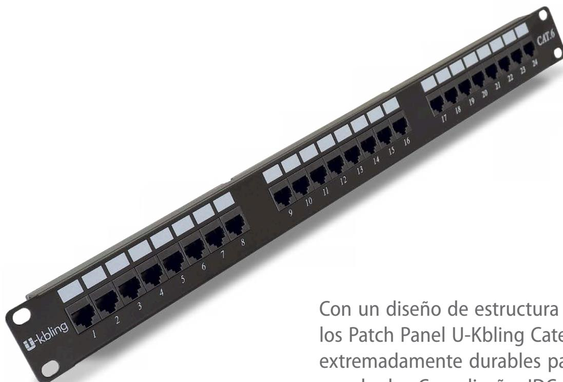
Con un diseño de estructura profesional, los Patch Panel U-Kbling Categoría 6 son extremadamente durables para el fuerte ponchado. Con diseño IDC 110 y tipo Krone doble, acepta herramientas de ponchado 110 y tipo Krone, y calibre de cables UTP rígidos desde 23 a 26AWG. Superficie de marcado grabable y borrrable para cada puerto en el panel frontal para la gestión eficiente del sistema.
