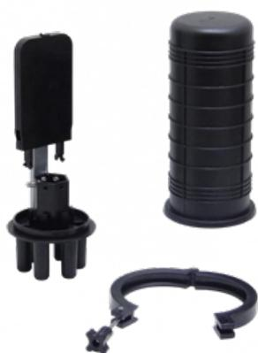
La mufa vertical de 24 se usa para conectar y proteger cables singulares de núcleo o grupo. Se puede colocar en aplicaciones subterráneas, aéreas, montadas en la pared, pedestales o enterradas directamente, montadas a mano y en conductos. El cierre es adecuado para las aplicaciones de hasta 96 fusiones, que pueden cubrir la mayoría de las aplicaciones en la transmisión de larga distancia y las redes locales de distribución de fibra, como FTTH / FTTC
